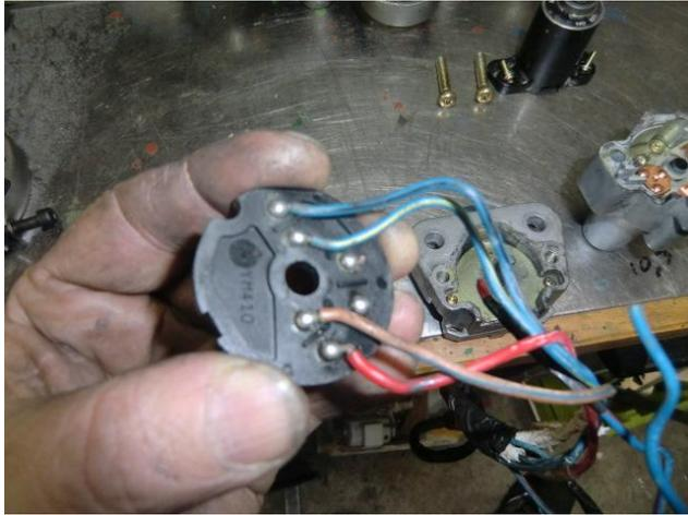
on voit à droite les deux emplacements ou les câbles manques , sur le disque noir il y a 2 encoches non centré donc impossible de perdre la position (une est au dessus de mon pouce 😊) comme c est ouvert , sous le disque noir il y a une petite tôle tenu par deux vis et en dessous le truc qui bloque le guidon , 💡vais y mettre un peu de graisse avant de refermer 😊
