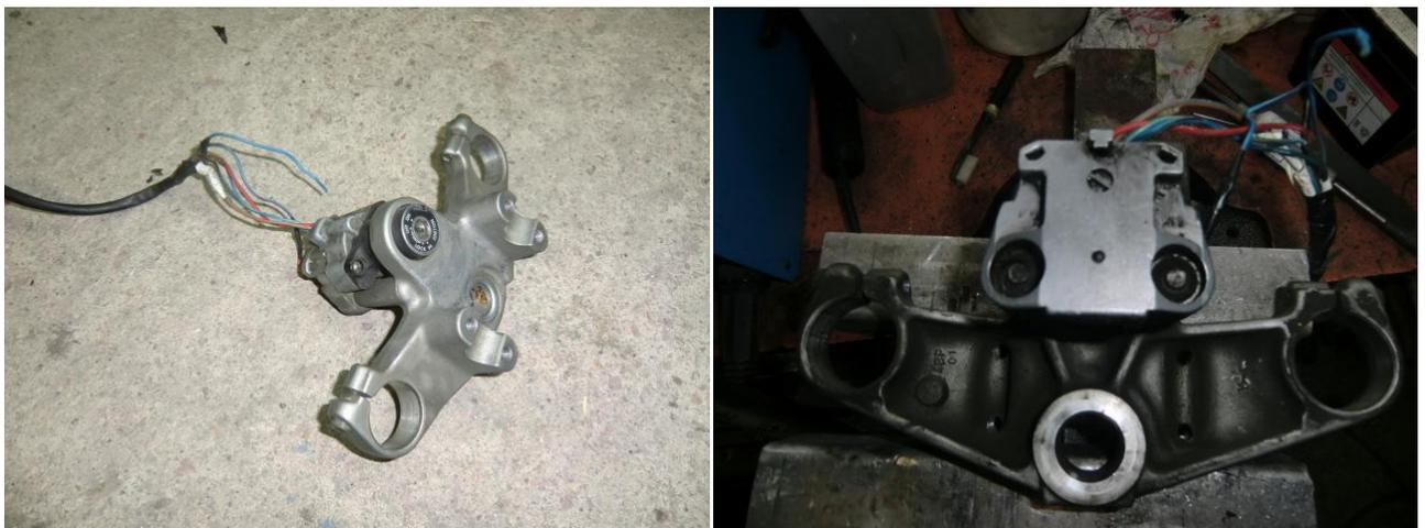
hop sur la perceuse, une fois le reste de tête percé, on peut sortir le reste du filetage qui sont bien collé au frein filet
