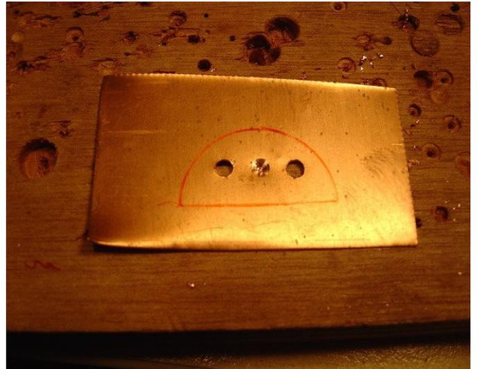
Découper la forme de la cale à l'aide de ciseaux de bricolage ou d'une cisaille à tôle, fignez avec une lime.
