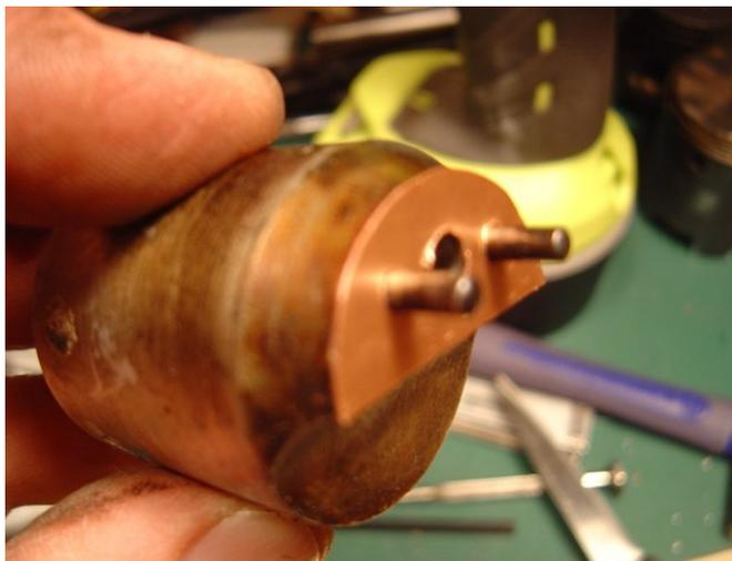
Une fois la valve assemblée, la cale doit dépasser un petit peu ( 1/2 mm maxi) sur la partie arrondie pour permettre un ajustement sur mesure ensuite.
