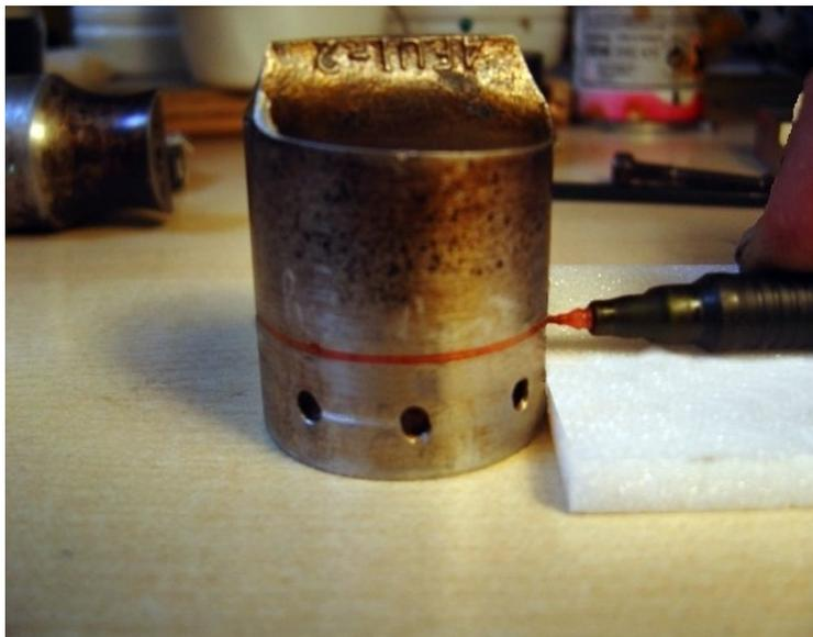
A l'aide d'une scie à métaux, commencer à scier sur le trait pour créer à terme une gorge d'une profondeur légèrement inférieure au diamètre de la tige d'acier qui sera utilisée pour réaliser le "segment". Pour ce qui me concerne, je disposais d'une Dremel et d'une très petite fraise (merci copain dentiste), avec laquelle j'ai figolé la gorge.
